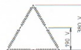
Verlaagd ontdooivermogen (elementen in de aansluitkast ompolen).
